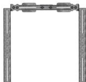
Sistema di fissaggio con fori oblunghi
